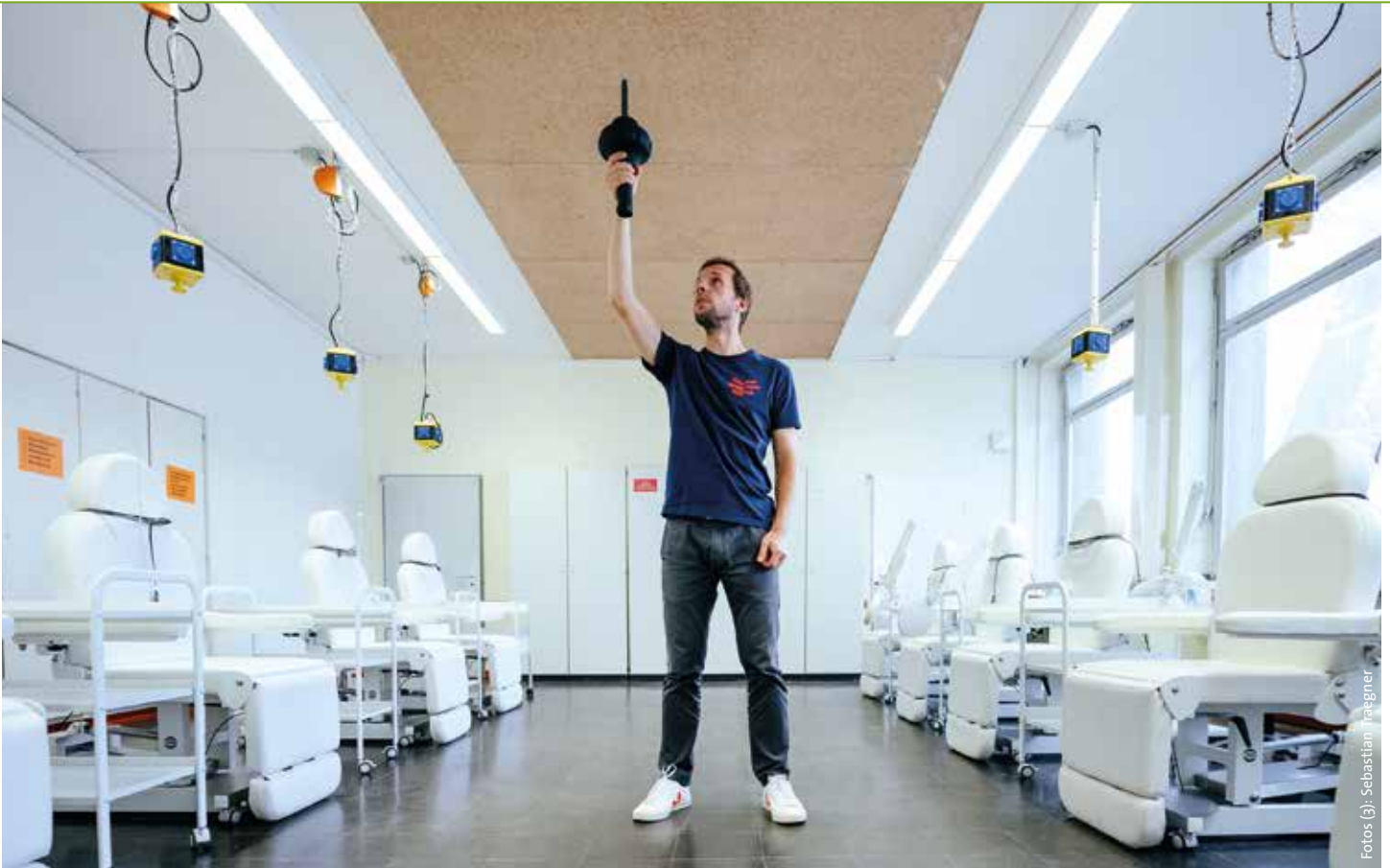
Dr. Silvan Siegrist erfasst per Lasermessung das komplette Aufmaß des Raumes.
